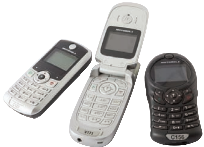
Старые мобильники Motorola на чипсете Calypso, на базе которых можно заниматься sniffингом GSM-трафика
